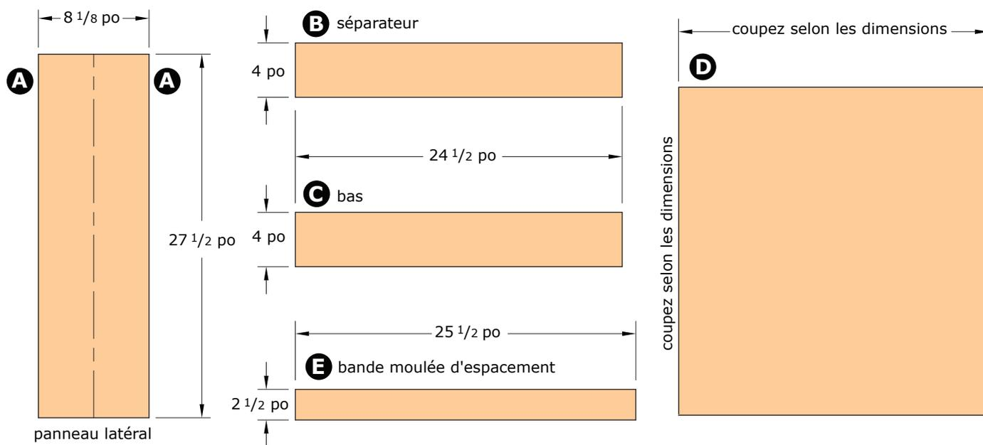
Dans le panneau latéral, façonnez une rainure de  $\frac{3}{4}$  po x  $\frac{1}{4}$  po de profondeur qui accueillera la pièce du haut et une feillure de  $\frac{3}{4}$  po x  $\frac{1}{4}$  po de profondeur qui accueillera la pièce du bas.
